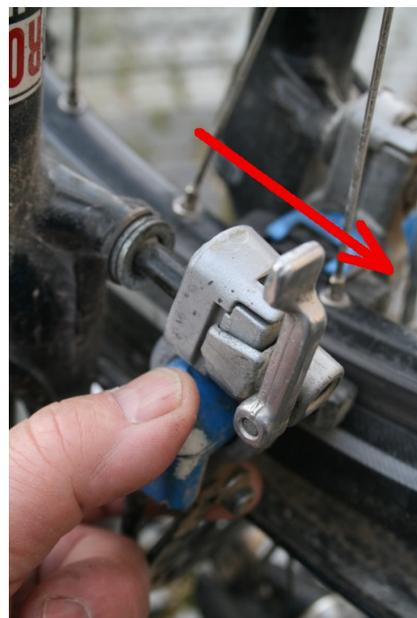
3. Bei hydraulischen Felgenbremsen einen Bremszylinder abbauen, ev. Unterlegscheiben vom Bolzen abziehen und in die Tasche stecken. Bei Seilzugbremsen muss das Seil ausgehängt werden.
