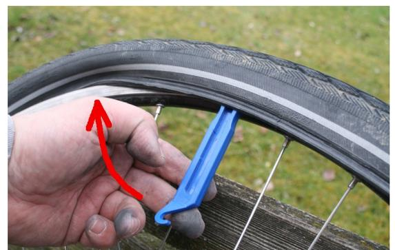
18. Luft wieder raus lassen, Schlauch in den Mantel legen, das Ventil durchs Loch stecken und eine Seite über die Felge ziehen. Anschließend die zweite Seite. Wahrscheinlich werden Sie noch einmal einen Reifenheber brauchen. Auf **Rotationsrichtung** des Mantels achten!
