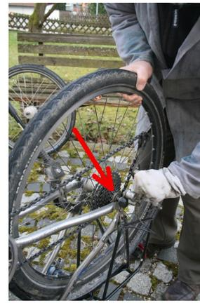
Hinterrad: Den alten Strumpf über die linke Hand ziehen, das Rad in die rechte Hand nehmen und in Position bringen, mit der linken Hand den oberen Teil der Kette über den Zahnkranz heben. Seitlich das Rad so positionieren, dass das kleinste Ritzel in den unteren Teil der Kette greift. Das Schaltsegment wird ein wenig nach hinten gezogen und die Achse in die Schlitz der Ausfallenden gedrückt. Nun wird noch der Schnellspanner angezogen und die Bremse befestigt (siehe 20).
