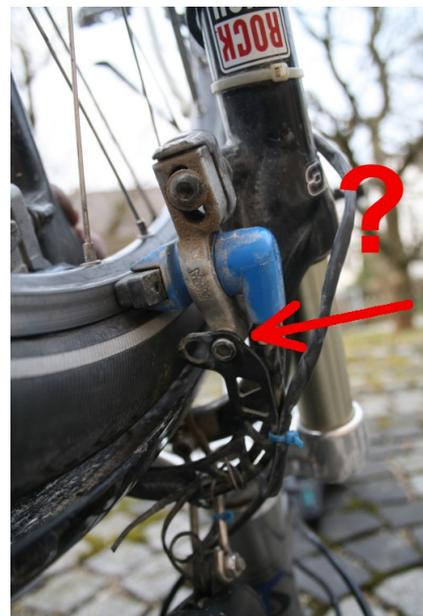
Bremszylinder wieder anbauen. Darauf achten, dass der Booster auf der anderen Seite nicht in der Luft hängt. Der Bremszylinder ist in der Senkrechten verschiebbar. Positionieren Sie ihn in der Höhe so, dass der Bremsklotz völlig auf der Felge liegt. Er darf auf keinen Fall am Mantel reiben.
