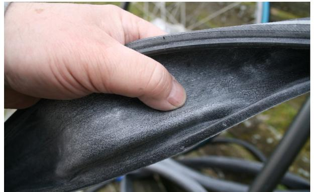
17. Schlauch nun auf den Mantel legen, so dass das Ventil auf der Markierung zu liegen kommt. Den Mantel an den Stellen, an denen der Flicker zu liegen kommt, genauestens innen und außen untersuchen, um den Übeltäter zu finden: Es kann ein Dorn, ein Glassplitter oder ein spitzer Stein sein. Diesen mit kleinem Schraubenzieher, Pinzette oder Spitzzange entfernen.
